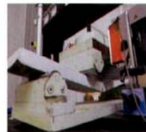
面外曲げ試験状況
